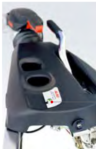
Magnetschalter zum Aktivieren des Senders
