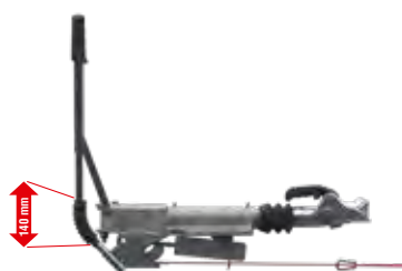
Handbremshebel geschlossen (Standbremse rückwärts, Bremse optimal eingestellt)
