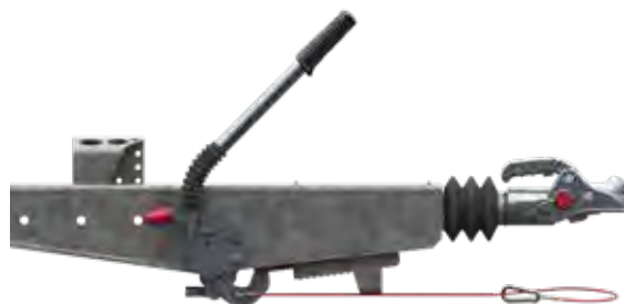
Handbremshebel geschlossen (Standbremse vorwärts)
