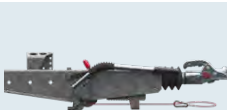
Handbremshebel geöffnet = Bremsgestänge nicht gespannt
