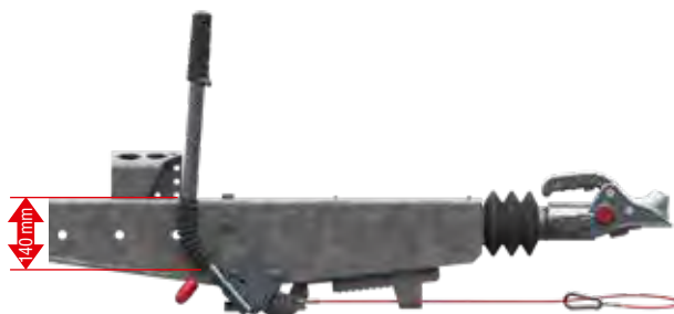
Handbremshebel geschlossen (Standbremse rückwärts, Bremse optimal eingestellt)
